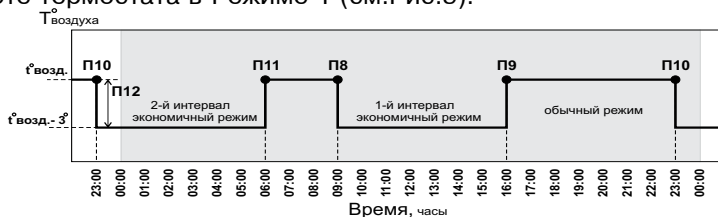
Рис.5 График температуры воздуха в помещении для Режим 1.
