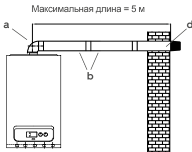
Рисунок 15 Монтаж дымохода с одним угловым отводом 90°.
