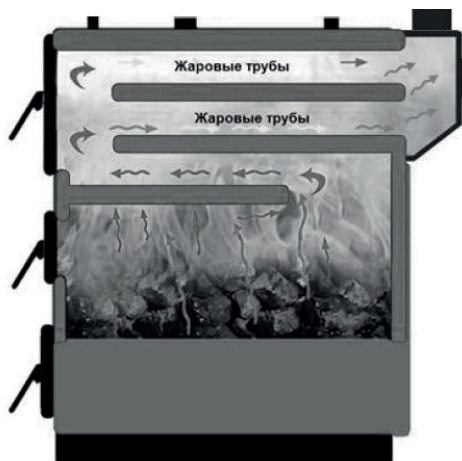
Рис. 3. Схема движения дымовых газов в трехходовом теплообменнике для котла VLK SRK-25-100.
