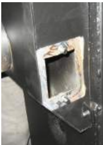
Рис. 10. Отверстие для чистки адаптера дымохода.
