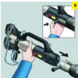
Установите пресс-бустер на пресс-инструмент и нажмите на крепежный болт до фиксации со щелчком.
