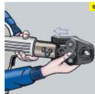
Установите пресс-клещи на пресс-инструмент. Вставьте стопорный болт до фиксации.
