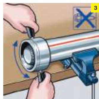
Снимите грат изнутри и снаружи трубы гратоснимателем.
