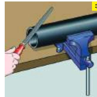
Снимите грат изнутри и снаружи трубы.
