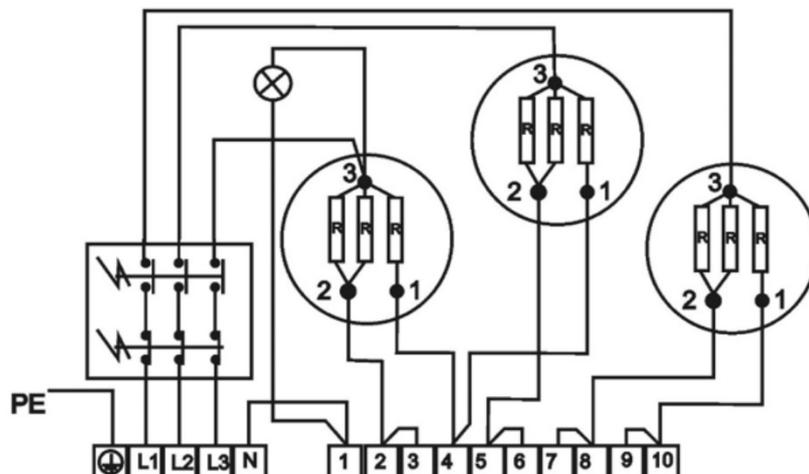
8kW 3 PE-N AC 400V / 50Hz
