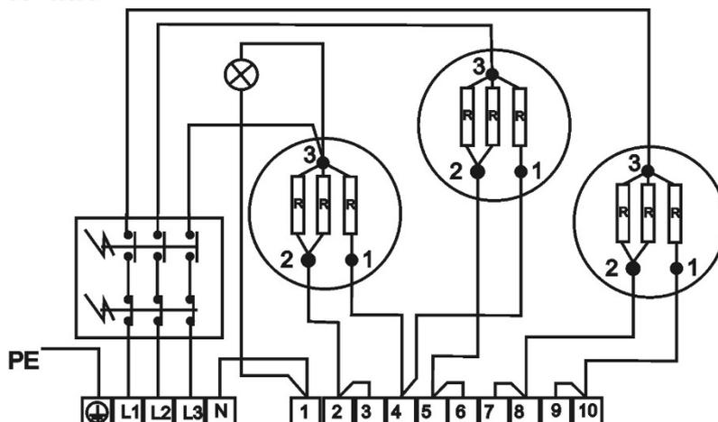
5kW 3 PE-N AC 400V / 50Hz
