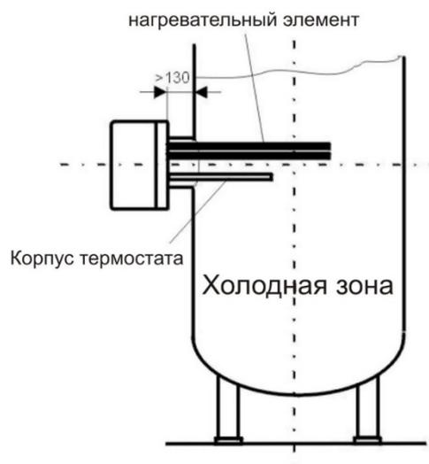
Фланец слишком длинный и высоко приварен. Гильза термостата под нагревательным элементом.
