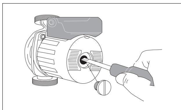
**!** При первом пуске циркуляционного насоса, и, по крайней мере, раз в год, рекомендуется проверять, свободно ли вращается вал. Поскольку, особенно после длительных периодов бездействия, отложения и грязь могут мешать нормальному вращению вала.
