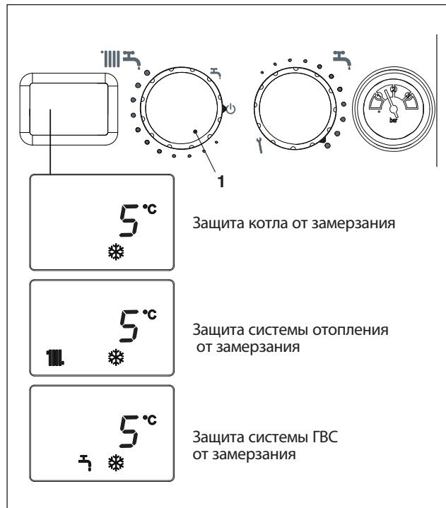
При этом электропитание остаётся подключённым, а трубопровод подачи топлива открытый. Котёл будет защищён следующими функциями:
