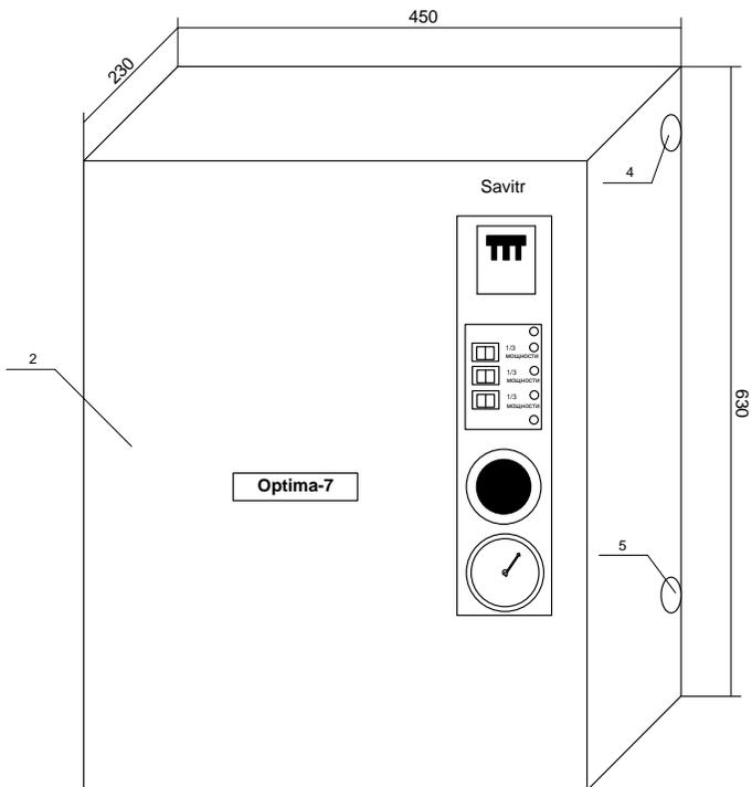
Рисунок 2. Общий вид водонагревателя «Star Optima»
