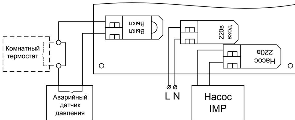
Рисунок 3. Колодка подключения внешнего оборудования
