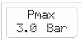
**Значение Pmax:** данный параметр используется для настройки рабочей точки устройства. Это постоянное значение давления, устанавливаемое пользователем для системы (максимальное давление). Когда система работает, устройство *Sirio Entry 230* приводит скорость работы электронасоса в соответствие с фактической мощностью, необходимой для оборудования пользователя, и, таким образом, поддерживает постоянное давление в системе.
