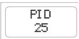
**Управление PID:** данный параметр используется для настройки скорости отклика системы на изменение давления (ускорение и замедление). Низкие значения PID обозначают медленный, но более точный отклик (более плавный пуск и остановка), в то время как более высокие значения данного
