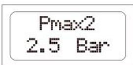
**Значение Pmax2:** данная страница отображается только в том случае, если параметр «AUXILIARY CONTACT» («ВСПОМОГАТЕЛЬНЫЙ КОНТАКТ») установлен на «3» (функция второй рабочей точки); данный параметр используется для настройки второй рабочей точки устройства. Если вспомогательный контакт внешне замыкается, значение давления Pmax2 становится новой рабочей точкой, в соответствии которой устройство *Sirio Entry 230* регулирует скорость работы электронасоса.
