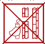
недостаточная тяга (Не используйте котел!)
