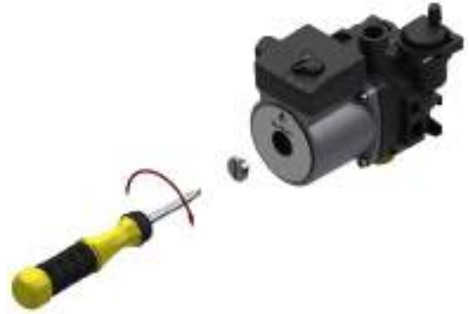
Рис. 5 Проверка циркуляционного насоса
