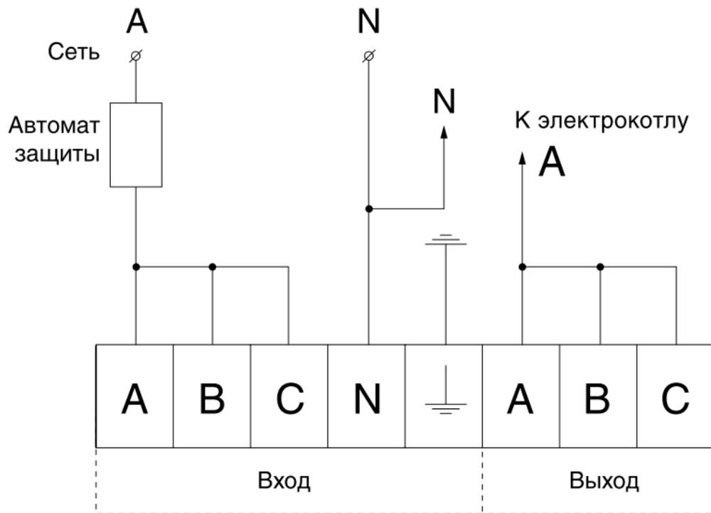
Рис. 2 Схема подключения электродотла на 220 В
