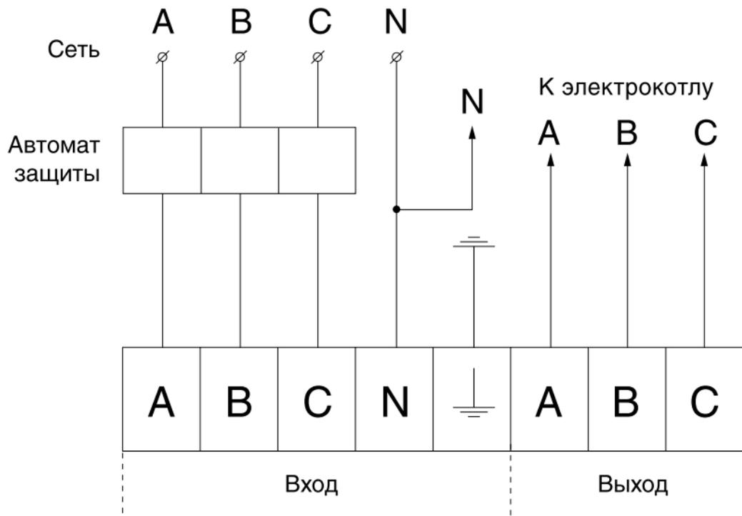
Рис. 1 Схема подключения электродотла на 380 В
