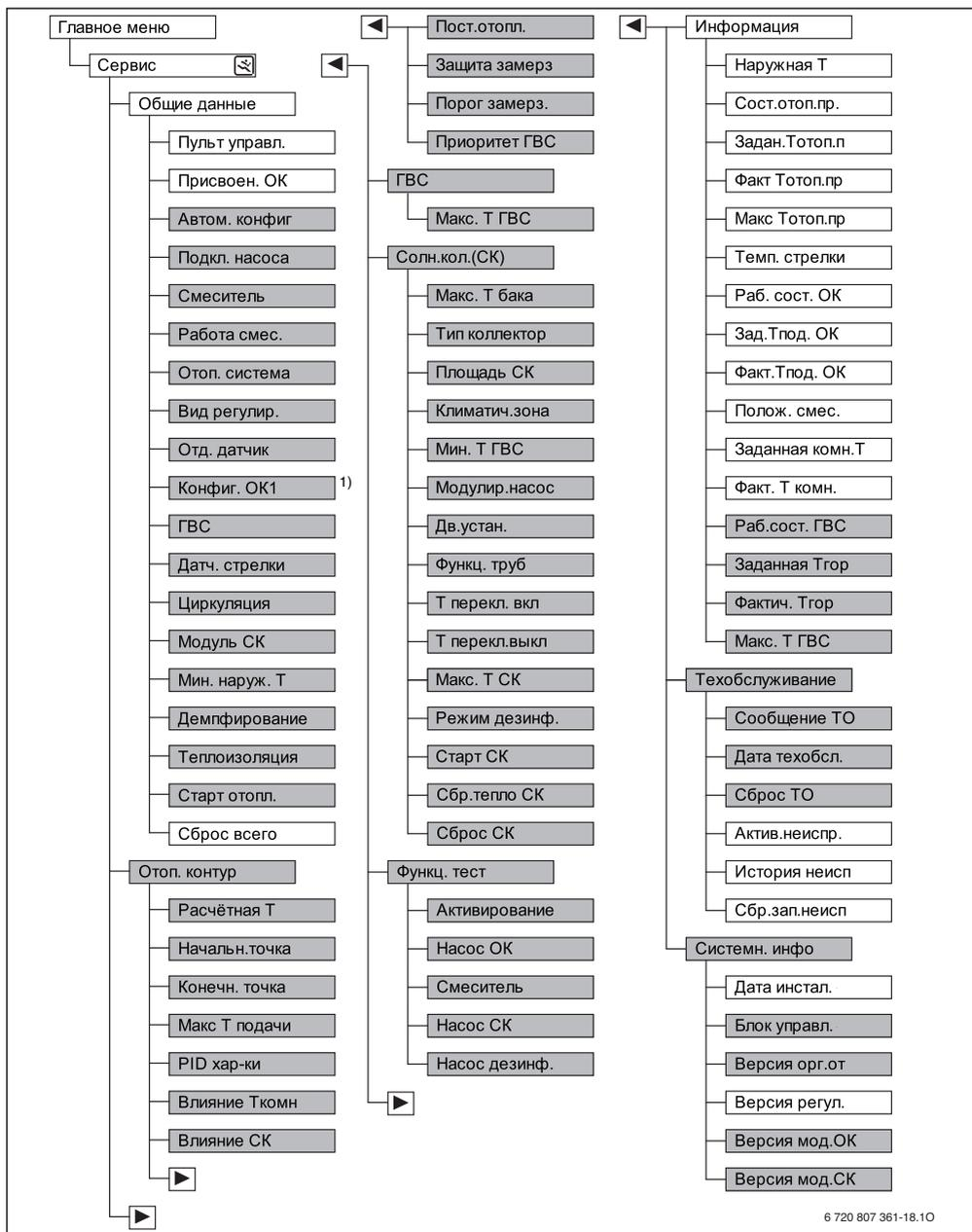
Рис. 11 Обзор сервисного меню - пункты меню, выделенные серым цветом, показаны только при использовании пульта как регулятора
