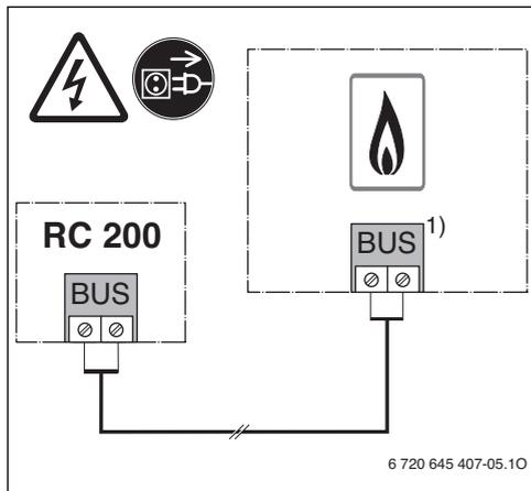
Рис. 6 Подключение пульта управления к теплогенератору
