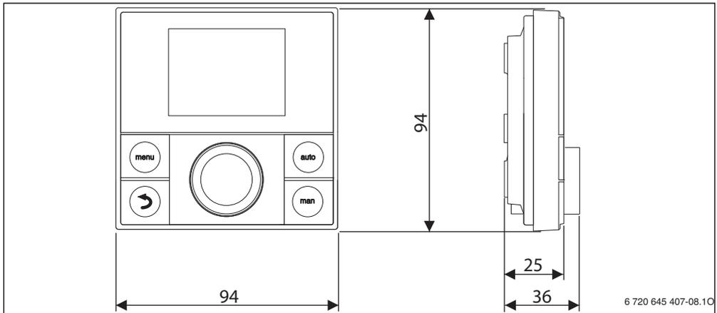
Рис. 3 Размеры, мм
