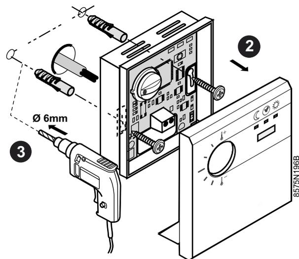
**⚠ 1** С помощью отвертки аккуратно высвободить выступы передней панели из выемок корпуса.
