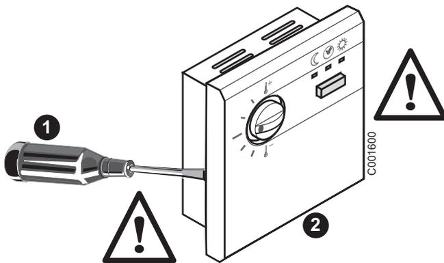
**⚠ 1** Dégager délicatement les ergots de la façade avant des nervures du boîtier à l'aide d'un tournevis.
