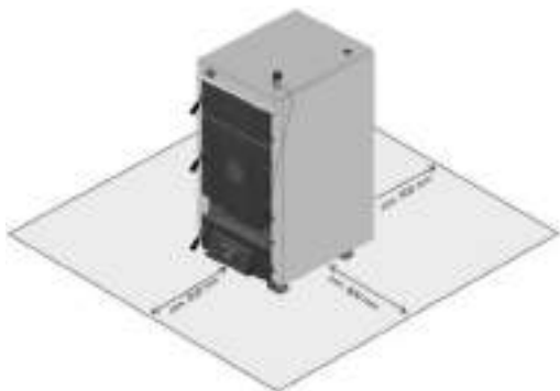
Рис. 10. Минимальные расстояния от котла до окружающих предметов
