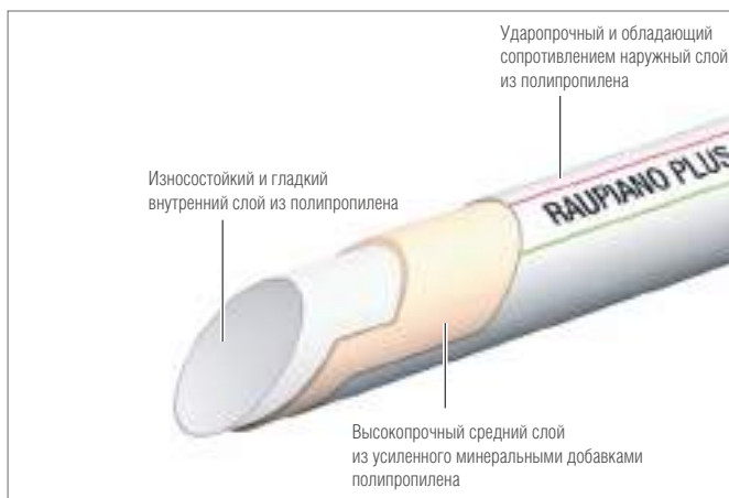
Рис. 2-3 Конструкция трубы RAUPIANO PLUS
