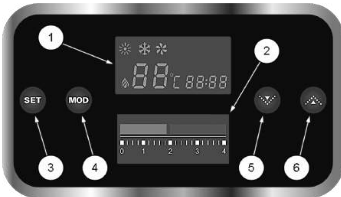
Рис. 40 Панель управления котлом.
