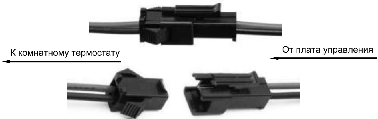
Рис. 43 Двухконтактный коннекторный разъём «папа-мама».
