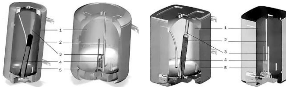
Рис.1. ЭВН Atlantic в разрезе и его составные части
