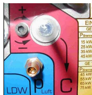
Рис. 19: Настроечный болт Logator GE1H с мерной В- шкалой
