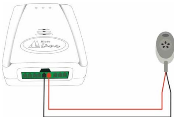
В комплект поставки входит проводной датчик температуры DS18S20 в пластиковом корпусе.
