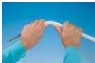
Изгиб при помощи внутренней спиральной пружины
