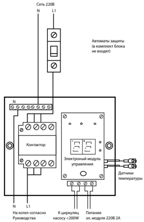
Рис.8. Схема подключения блока Навигатор ЛЮКС 6.
