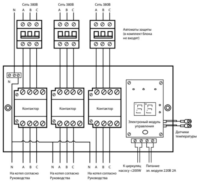
Рис.7. Схема подключения блоков «Навигатор ТТ».
