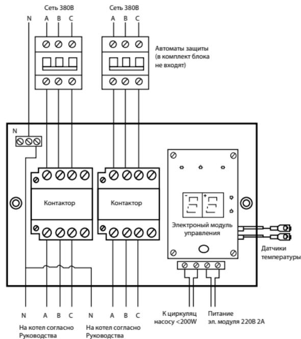
Рис.4. Схема подключения блоков
