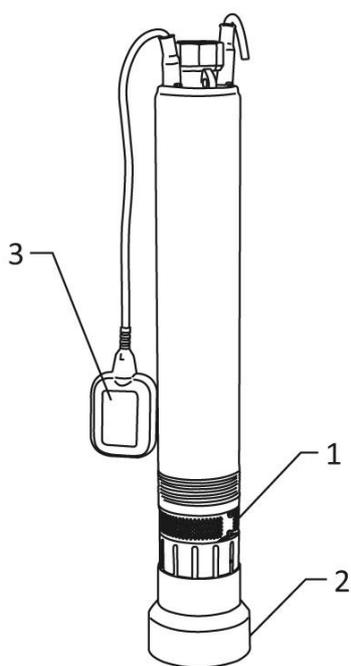
Насосы серии ECO FLOAT представляют собой центробежные моноблочные многоступенчатые насосы с корпусом из нержавеющей стали.
