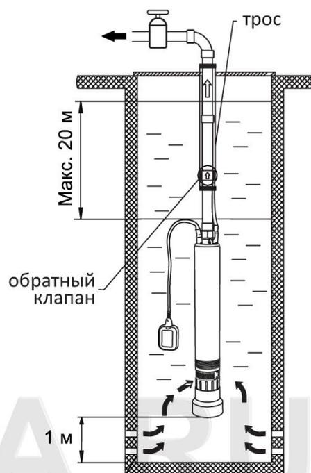
**⚠ ВНИМАНИЕ!** Во время эксплуатации сетчатый фильтр водозаборной части должен быть постоянно полностью погружен в перекачиваемую жидкость.
