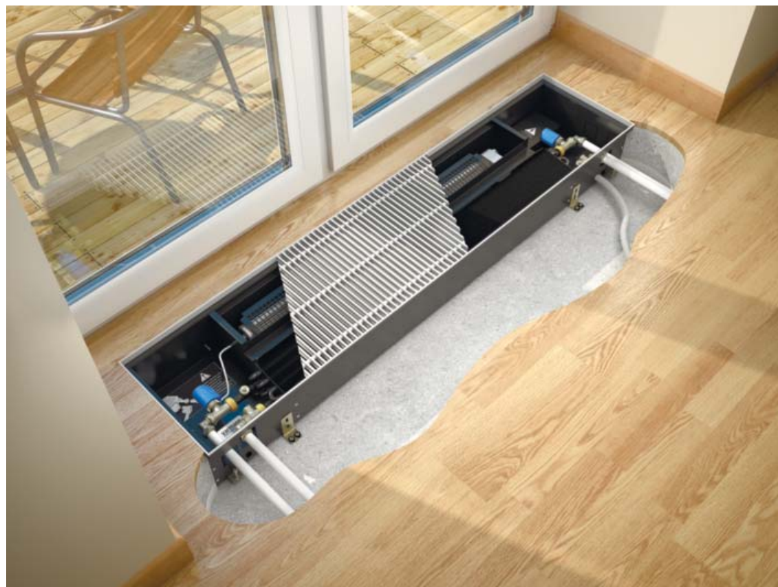
Монтаж конвектора Qtherm НК4 310.130 в четырехтрубную систему с подключением теплоносителя "справа" и холодоносителя "слева", расположение вентиляторов со стороны окна.
