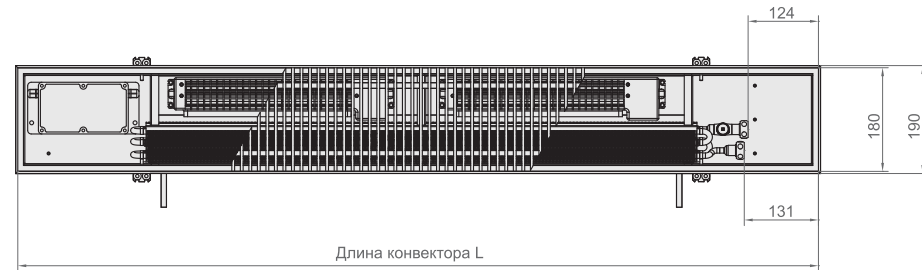
Вид сверху конвектора Qtherm НК Mini 190.90 с роликовой решеткой, с U-образным бортом.
