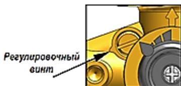
В данном положении подключаемый байпас находится в полностью открытом положении и обеспечивает максимальную рециркуляцию. Положение регулирующего винта находится на одной линии с указателем исходного положения.
