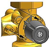
Стрелки указывают на винты блокировки указателя вращательной головки и оси регулирования
