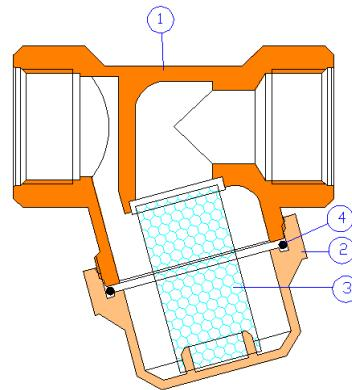
Фильтр состоит из корпуса 1, заглушкы 2, фильтроэлемента 3 и уплотнительного кольца 4. Корпус и заглушка фильтра выполнены из горячепрессованной латуни марки CW617N (ЛС59-2) с гальванопокрытием из никеля.
