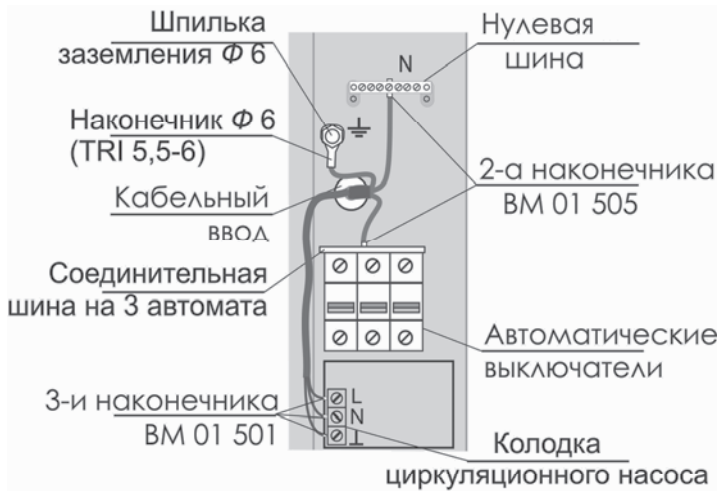
Рис.3 Подключение РусНИТ - 205К, к однофазной сети
