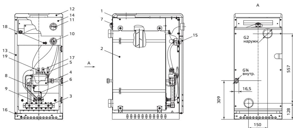
1 — устройство газоотводящее; 2 — теплообменник; 3 — горелка основная; 4 — газовый клапан; 5 — пьезорозжиг;
