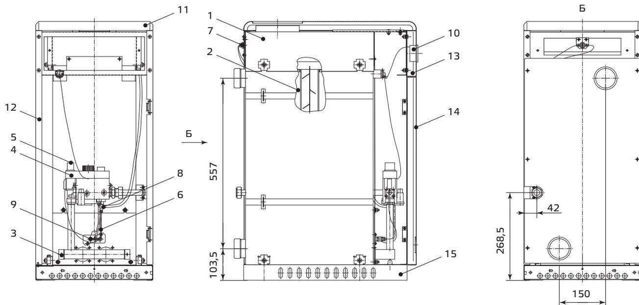
1 — газоотводящее; 2 — теплообменник; 3 — горелка основная; 4 — газовый клапан; 5 — пьезорозжиг; 6 — термopapa; 7 — датчик тяги; 8 — термopрерыватель; 9 — запальная горелка (пилотная); 10 — термометр; 11 — крышка; 12 — стенка боковая левая/правая; 13 — панель; 14 — стенка передняя; 15 — рама
