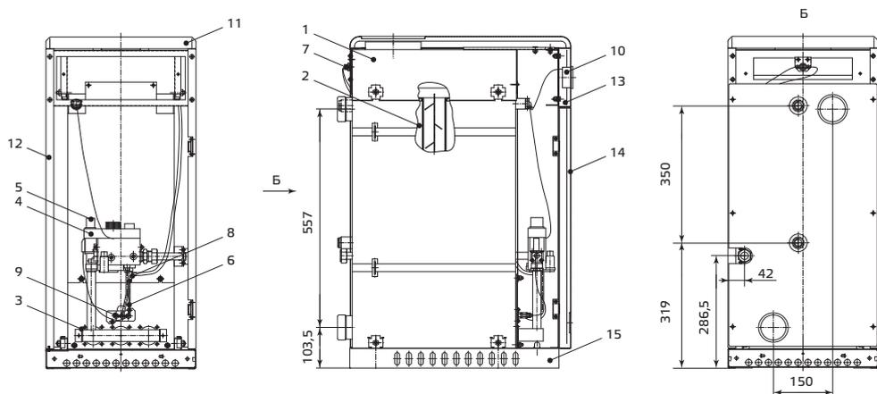
1 — газоотводящее; 2 — теплообменник; 3 — горелка основная; 4 — газовый клапан; 5 — пьезорозжиг;
