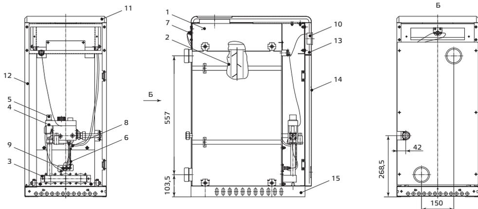
1 — газоотводящее; 2 — теплообменник; 3 — горелка основная; 4 — газовый клапан; 5 — пьезорозжиг;
