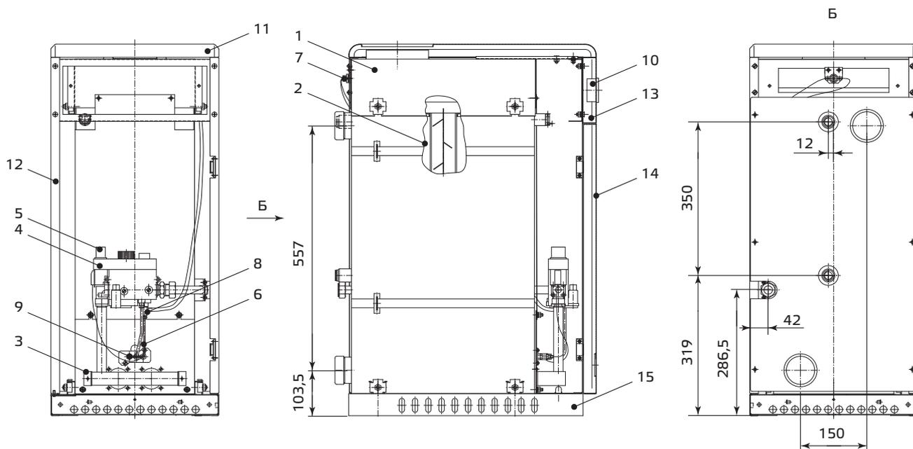
1 — газоотводящее; 2 — теплообменник; 3 — горелка основная; 4 — газовый клапан; 5 — пьезорозжиг; 6 — термopapa; 7 — датчик тяги; 8 — термopрерыватель; 9 — запальная горелка (пилотная); 10 — термометр; 11 — крышка; 12 — стенка боковая левая/правая; 13 — панель; 14 — стенка передняя; 15 — рама
