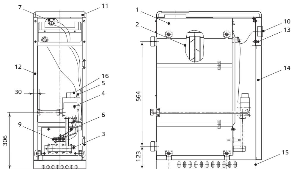
1 — газоотводящее; 2 — теплообменник; 3 — горелка основная; 4 — газовый клапан; 5 — крышка с пьезорозжигом; 6 — термopapa; 7 — датчик тяги; 8 — тягопрерыватель; 9 — запальная горелка (пилотная горелка); 10 — термометр; 11 — крышка; 12 — стенка боковая левая/правая; 13 — панель; 14 — стенка передняя; 15 — рама; 16 — ручка-указатель терморегулятора (кнопка клапана магнитного)
