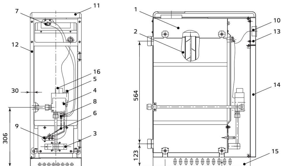
1 — газоотводящие; 2 — теплообменник; 3 — горелка основная; 4 — газовый клапан; 5 — крышка с пьезорозжигом; 6 — термopapa; 7 — датчик тяги; 8 — тягопрерыватель; 9 — запальная горелка (пилотная горелка); 10 — термометр; 11 — крышка; 12 — стенка боковая левая / правая; 13 — панель; 14 — стенка передняя; 15 — рама; 16 — ручка-указатель терморегулятора (кнопка клапана магнитного).
